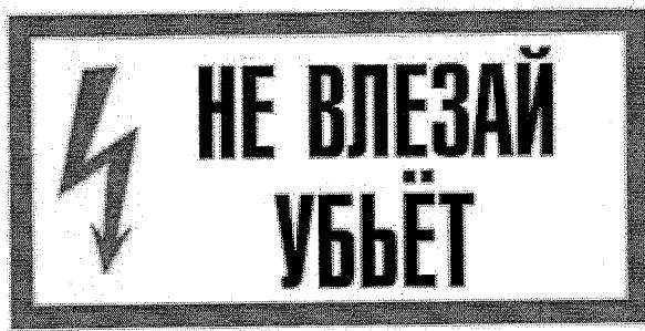
(предупреждает об опасности подъема по конструкциям, при котором возможно приближение к токоведущим частям, находящимся под напряжением)
